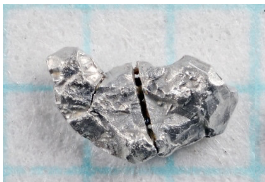
図 1: イソフェロプラチナ鉱 (Isoferroplatinum: \text{Pt}_3\text{Fe} ) (背景 1 マス 1 mm)
