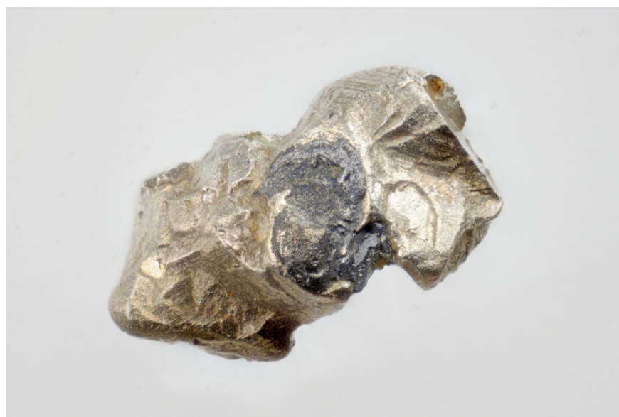
図 2 : 不知火鉱 (写真中央黒色部) を含む砂白金 (FOV = 4 mm)
