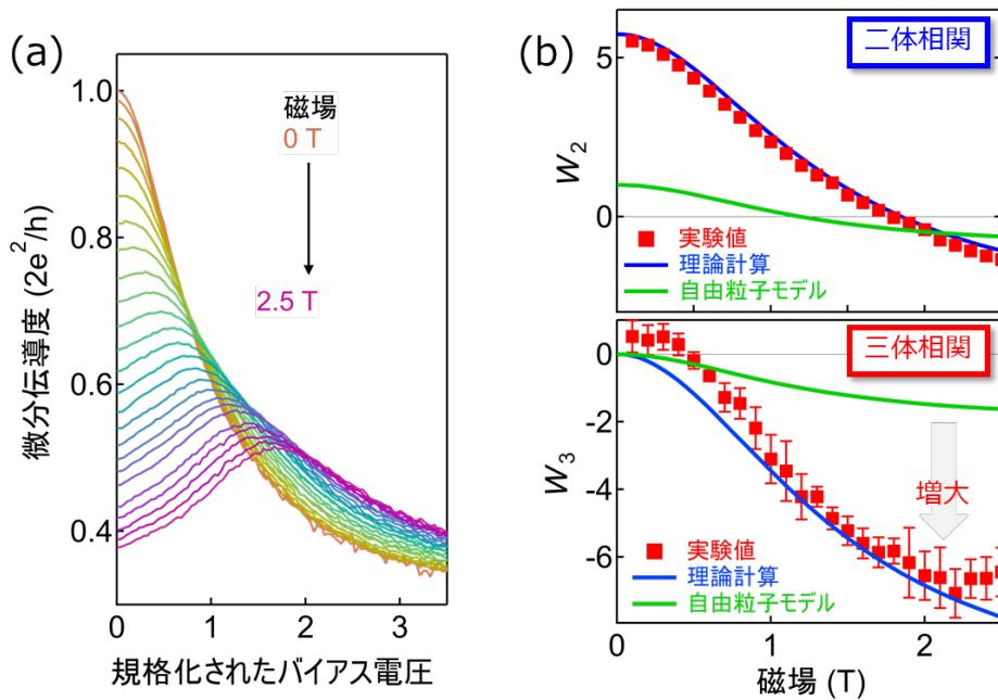
図2 (a) バイアス電圧を変化させたときの量子液体の電気伝導度の測定結果を示します(バイアス電圧は近藤効果のエネルギー階級で規格化されています)。各曲線は、磁場を0 Tから2.5 Tまで段階的に変化させたときの測定結果です。バイアス電圧あるいは磁場が増加すると、量子液体の伝導度が大きく変化します。この変化の様子から量子液体中における粒子の相互作用を検出することができます。(b) (a)に示した測定結果を解析して得られた二体相関と三体相関をプロットしています。赤色が実験結果、青色実線が非平衡領域における局所フェルミ液体論に基づく理論計算、緑色が量子多体効果を考慮しない自由粒子モデルを示します。自由粒子モデルでは実験結果を全く説明できることや、磁場が増大するとともに三体相関が(負の方向に)増大していることが分かります。
