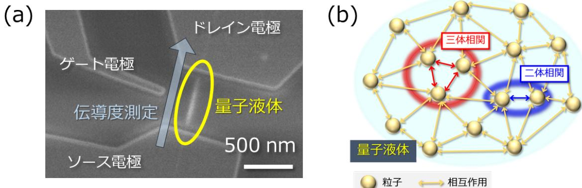
図1(a) 実験に用いた試料の電子顕微鏡写真。黄色い点線で囲まれた領域に見える白い筋が、カーボンナノチューブからなる人工原子です。この人工原子にただひとつの電子を閉じ込め、それによって生じる近藤効果によって、量子液体を生成しました。この量子液体はソース電極とドレイン電極の間に閉じ込められています。この量子液体の電気伝導度を精密に測定しました(測定結果を図2(a)に示しています)。(b) 量子液体の模式図。たくさんの粒子(電子)から構成されています。粒子2つの間に生じる相互作用(二体相関)と、粒子3つの間に生じる相互作用(三体相関)を、青色と赤色で模式的に表しました。
