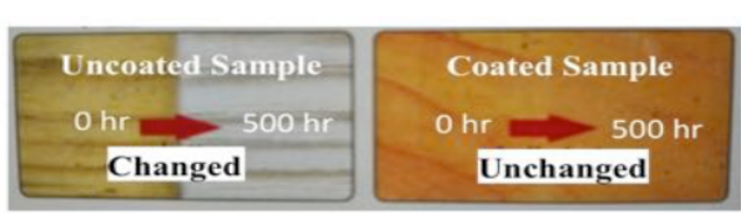
図 5 超越コーティングによる木材の耐候性の変化。
