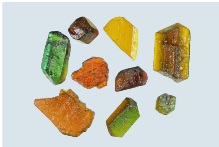
図1 多色性を示す Ca 3 ReO 5 Cl 2 の結晶
