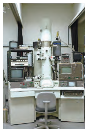
200 kV 電界放射形分析電子顕微鏡
