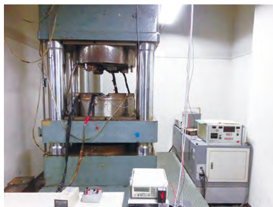
若槻型 700 ton キュービックプレス。4 GPa までの高温高压合成実験用。 Wakatsuki-type 700 ton cubic press for high pressure and high temperature synthesis experiments up to 4 GPa.
