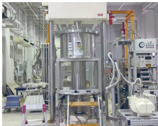
定荷重キュービックアンビル高压装置。等方的加圧と液体圧力伝達媒体により、静水圧性の高い高压実験環境を実現する。
