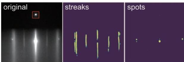
回折パターンでトレーニングされた UNet ニューラル ネットワークを使用した RHEED パターンからの回折ストリークとスポットの抽出。直接ビーム(元の画像の赤枠)は回折スポットと混同されない。
