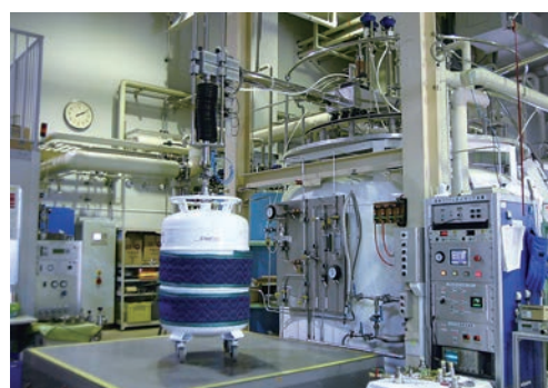
ヘリウム液化機、貯槽及び遠心汲み上げポンプ Helium liquefier, storage, and transfer system
