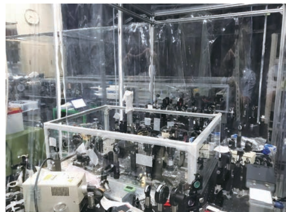
テラヘルツ電磁応答および Hall 伝導測定に用いる透過・反射・偏光回転精密計測システム
