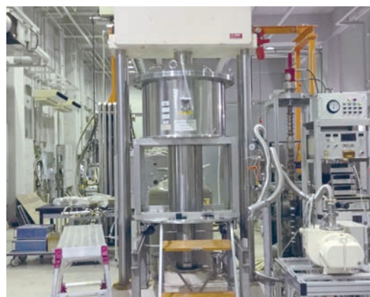
定荷重キュービックアンビル高圧装置。等方的加圧と液体圧力伝達媒体により、静水圧性の高い高圧実験環境を実現する。
