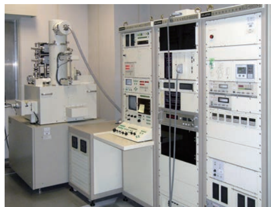
電子線リソグラフィー装置 (エリオニクス)。最高加速電圧は 75 kV。ビーム径は 2 nm。
