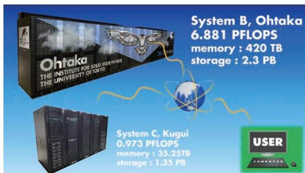
物性研究所共同利用スーパーコンピュータシステム構成図 The Supercomputer System at the SCC-ISSP.
