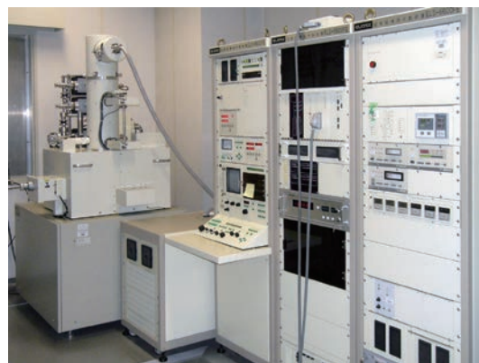
電子線描画装置 (エリオニクス)。最高加速電圧は 75 kV。 ビーム径は 2 nm。
