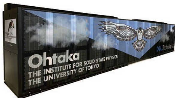
スーパーコンピュータシステム B, Ohtaka (Dell PowerEdge C6525/R940) The supercomputer system B, Ohtaka (Dell PowerEdge C6525/R940)
