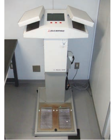
ハンドフットクロスモニター The 7ch hand-foot-clothing monitor
