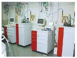
磁気特性測定装置 SQUID magnetometer (MPMS)
