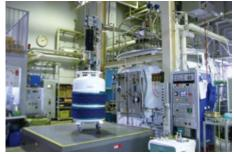
、リウム液化機、貯槽及び遠心汲み上げポンプ Helium liquefier, storage, and transfer system
