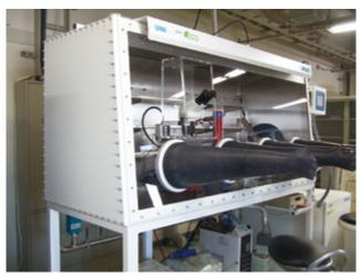
試料調整用グローブボックス Glove box for sample preparation
