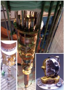
物性研の核断熱消磁冷凍機。超低温(1 mK)・高磁場(10 T) の実験が可能。左下挿図が実験空間拡大写真。右下挿図が超低温トルク測定用カンチレバー。
