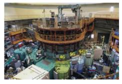
日本原子力研究開発機構(JAEA)の研究炉 JRR-3 の炉室に設置された 3 台の大学所有の 3 軸分光器(4G,5G,6G)。これ以外にガイドホールで所有する様々なタイプの9台の中性子分光器を用いて、研究室の独自研究と全国共同利用を行っている。
