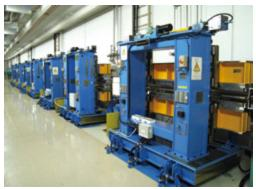
SPring-8 BL07LSU の 8 台の Figure-8 アンジュレーター。本挿入光源より連続 偏角可変型不等間隔刻線平面回折格子分光器を経て、各実験ステーションに高輝度 敵 X 線が併給される
