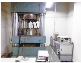
若槻型700tonキュービックプレス。4GPaまでの高温高圧合成実験用。 Wakatsuki-type 700 ton cubic press for high pressure and high temperature synthesis experiments up to 4 GPa.
