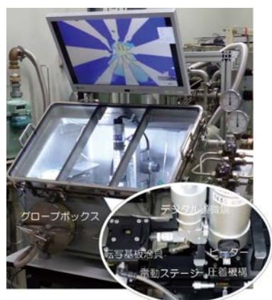
原子層転写積層装置。不活性ガス雰囲気中で、バルク結晶から劈開単離した単原子層結晶を、位置調整して積層圧着し、複合原子層（ファンデルワールスヘテロ構造）を作成する。空気中で不安定な原子層物質や複合原子層系の試料作製に威力を発揮する。
