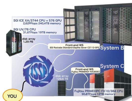
物性研究所共同利用スーパーコンピュータシステム構成図 The Supercomputer System at the SCC-ISSP.
