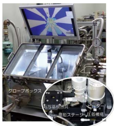
原子層転写積層装置。不活性ガス雰囲気中で、バルク結晶から劈開分離した単原子層結晶を、位置調整して積層圧着し、複合原子層（ファンデルワールスヘテロ構造）を作成する。空気中で不安定な原子層物質や複合原子層系の試料作製に威力を発揮する。
