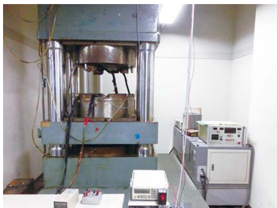
若機型 700ton キュービックプレス。4GPa までの高温高圧合成実験用。
