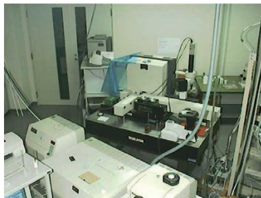
赤外およびラマン分光装置 IR and Raman Spectrometers (Room A468)
