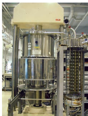
キュービックアンビル型圧力発生装置。 多重極限状態（低温・強磁場・高圧） での物性測定が可能である。
