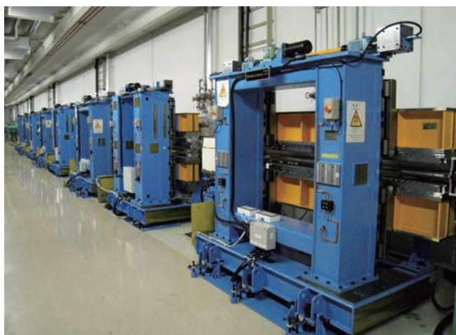
SPring-8 BL07LSU の 8 台の Figure-8 アンジュレーター。本挿入光源より連続偏角可変型不等刻線間隔平面回折格子分光器を経て、各実験ステーションに高輝度軟 X 線が供給される。Figure-8 undulators installed in SPring-8, which provide high-brilliance synchrotron radiation into the beamline BL07LSU.
