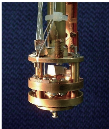
極低温ファラデー磁力計に用いるキャパシタンス荷重計。最低温30 mKで17 Tまでの磁化測定が可能である。
