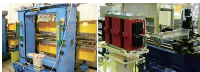
SPRING-8に設置された東京大学物質科学ビームラインの偏光制御アンジュレータ（左）と高速円偏光切替のための移相器プロトタイプ磁場測定（右）。
