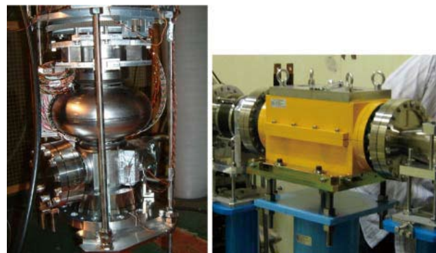
次世代放射光源のための超伝導加速空洞の単セルモデル（左）と新しい入射方式のために PF リングに設置されたパルス六極電磁石（右）。
