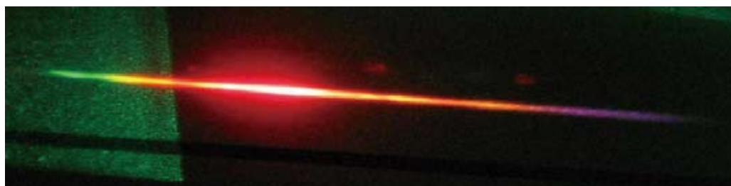
オクターブバンドチタンサファイアレーザーのスペクトル。レーザーの出力を回折格子で分光したもの。繰り返し1 GHz、パルス幅は5.6 fs。 Spectrum of the octave-spanning Ti:sapphire laser oscillator. The repetition frequency is 1 GHz, and the pulse duration is 5.6 fs.
