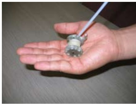
放射光 X 線実験に用いる超小型パルスマグネット。内径 3 mm の小さなながら、50 テスラの強磁場発生が可能。
