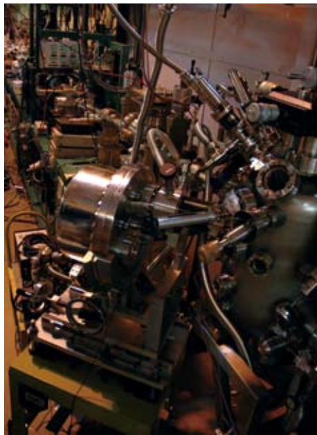
BL-18A とエンドステーション。ここで、真空紫外線から軟X線放射光による高分解能フェルミマッピング、バンドマッピング、波動関数の対称性決定などの実験を行うことができる。
