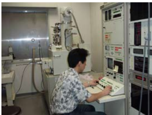
電子線描画装置。75keV 加速電子線によって 10nm までのレジスト加工が可能。レーザー干渉ステージによって 50nm の位置合わせ精度を持つ。
