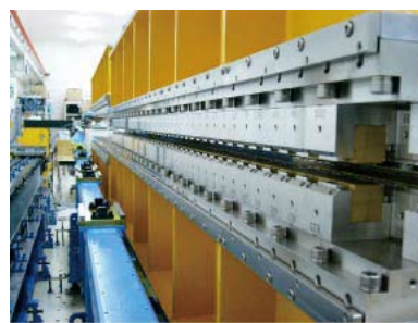
SPring-8に建設する東京大学物質科学ビームラインの偏光制御アンジュレータ（左）と高速円偏光切替のための移相器プロトタイプ（右）。
