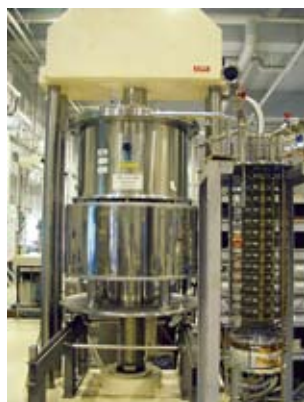
キュービックアンビル型圧力発生装置。 多重極限状態（低温・強磁場・高压） での物性測定が可能である。
