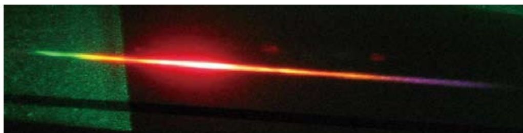
オクターブバンドチタンサファイアレーザーのスペクトル。レーザーの出力を回折格子で分光したもの。繰り返し1 GHz、パルス幅は5.6 fs。
