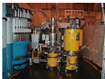
日本原子力研究開発機構（JAEA）の研究炉 JRR-3 に設置された物性研究所の3軸型中性子分光器。
