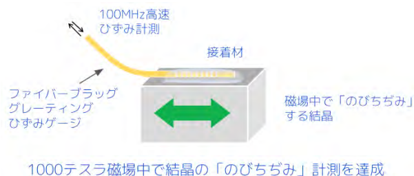
図2 爆発を伴う超強磁場発生中に一瞬のうちに一発で「のびちぢみ」を計測するために利用した超高速ひずみ計測装置の概略図。計測対象の結晶側面に光ファイバーを接着します。光ファイバーはファイバーブラッググレーティングという「ひずみゲージ」の機能を持つものを使用しています。「のびちぢみ」はファイバーを通して離れた場所で検出します。特別に開発した100メガヘルツ超高速計測法を利用して、一瞬のうちに一発でひずみを計測します。
