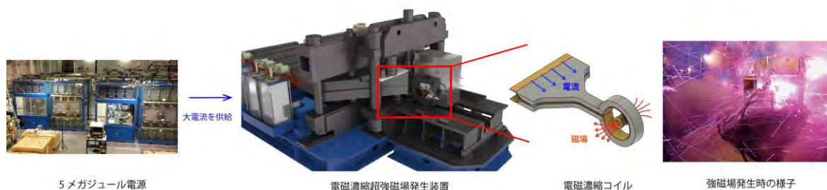
図 1 1000 テスラ発生に用いる新型電磁濃縮法装置の概念図。まず 5 メガジュールのコンデンサ電源に電気エネルギーを蓄積します。つぎに電磁濃縮コイルに放電します。電磁濃縮コイルは受け取ったエネルギーを利用して、金属ライナー(筒)を高速収縮します。金属ライナー中の初期磁束(3 テスラ程度)は急速に高密度化し 1000 テスラ級の超強磁場が発生します。超強磁場発生直後にコイルは大爆発します。この爆発は金属ライナーを収縮するさせる際の反作用と、発生した超強磁場自体の反発力によるものです。
