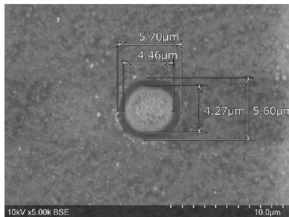
図 3: ABF にあけた微細穴の電子顕微鏡写真。6 ミクロン以下の穴が開いていることが分かる。
