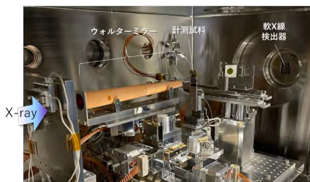
図1 開発した軟X線顕微鏡の配置(上)と計測装置の内部写真(下)。写真中でのオレンジ色の筒型部品が新たに開発した軟X線全反射ウォルターミラー。
