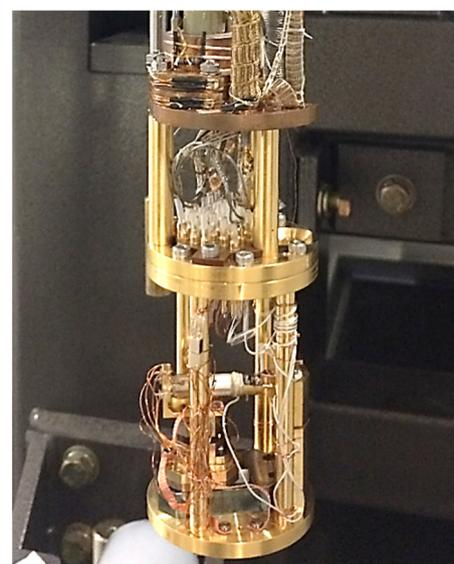
図 2: 希釈冷凍機に設置された STM 装置。チューブスキャナは横方向に移動する。
