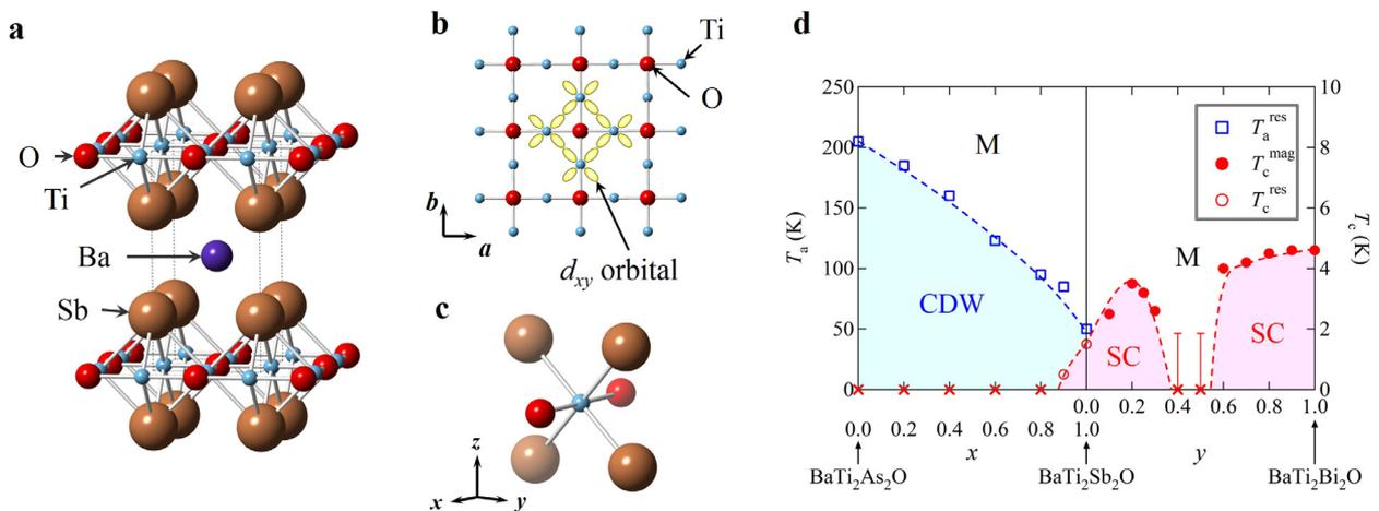
Figure a, BaTi<sub>2</sub>Sb<sub>2</sub>O の結晶構造。b, TiO<sub>2</sub> 正方格子。d<sub>xy</sub> 軌道が Ti-Ti 方向に伸びている。c, TiO<sub>2</sub>Sb<sub>4</sub> 八面体配位。d, BaTi<sub>2</sub>Pn<sub>2</sub>O (Pn = As, Sb, Bi) の電子相図。SC は超伝導相、CDW は電荷密度波相、M は金属相を表す。
