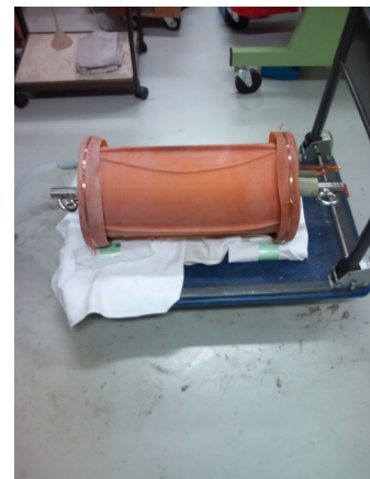
図2 45テスラ、1秒間の磁場を発生するマグネット。この外側にもう一段のコイルを巻けば完成である。
