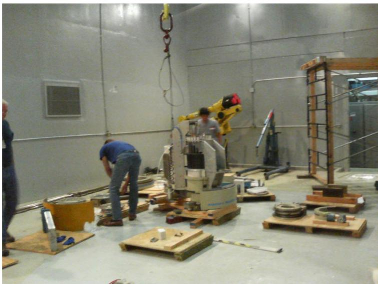
図 4: オークリッジ国立研究所のとある蒸し暑い地下室での CTAX-2 分光器解体作業。文字通り完全に分解し、部品の採寸と日本に運搬すべき部品の選別を行った。
