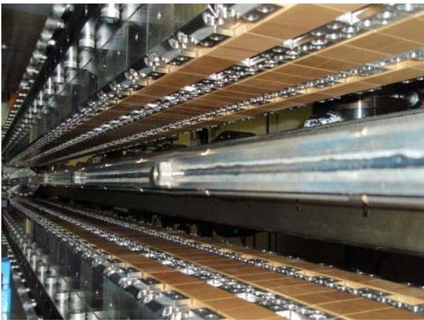
図 4. 水平偏光型 8 の字アンジュレータの磁石列
