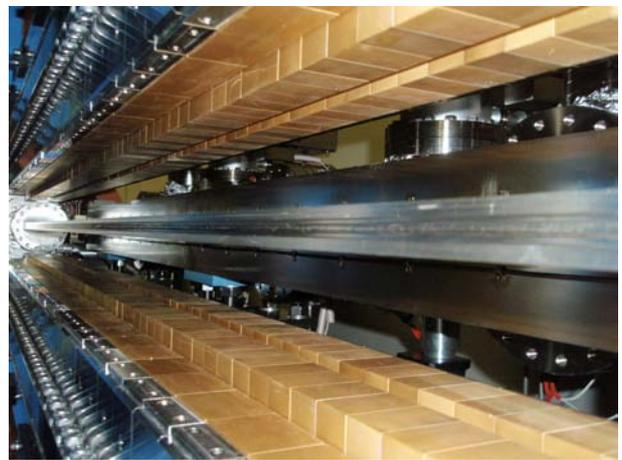
図 5. 垂直偏光型 8 の字アンジュレータの磁石列
