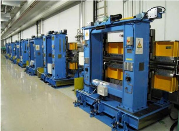
図 3. Spring-8 蓄積リング直線部に設置された水平及び垂直偏光型 8 の字アンジュレータ 8 台
