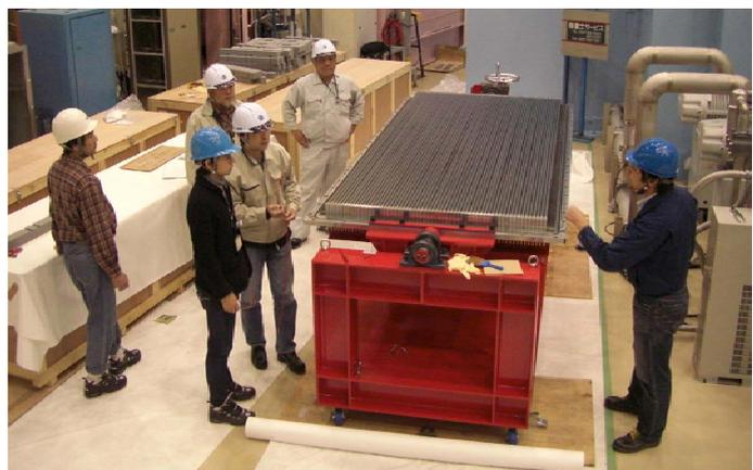
図 1: BL12/HRC 分光器の検出器取り付け作業の様子。
