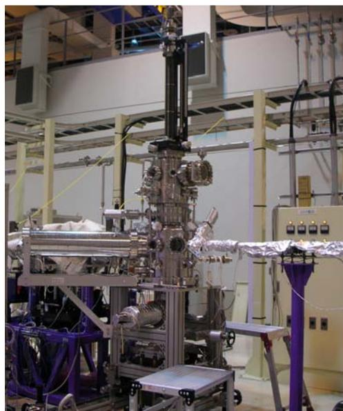
図 7. 時間分解軟 X 線分光実験ステーション (TR-SX spectroscopy)
