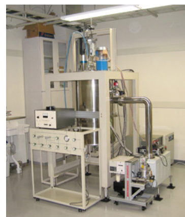
図 9. 蒸着試料用断熱型熱量計
