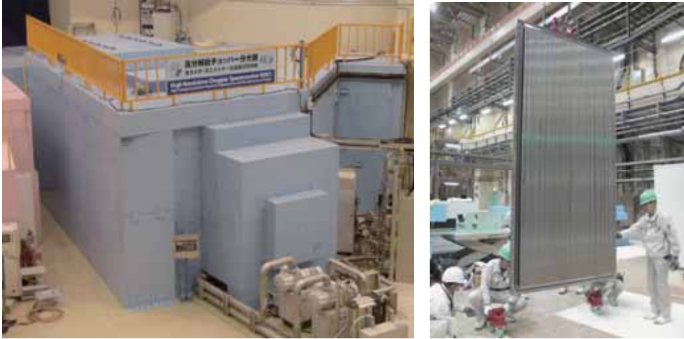
図 1: (左)高分解能チョッパー分光器と(右)大立体角検出器設置作業風景
