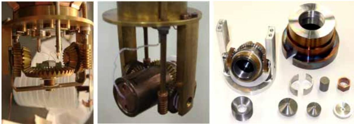
図 9 (左) 試料回転用 2 軸ゴニオメータを備えた NMR プローブ。(中央) 2 軸ゴニオメータにセットされたピストン・シリンドー型圧力セル。(右) 現在開発中の対向アンビル型圧力セルと 2 軸回転機構。
