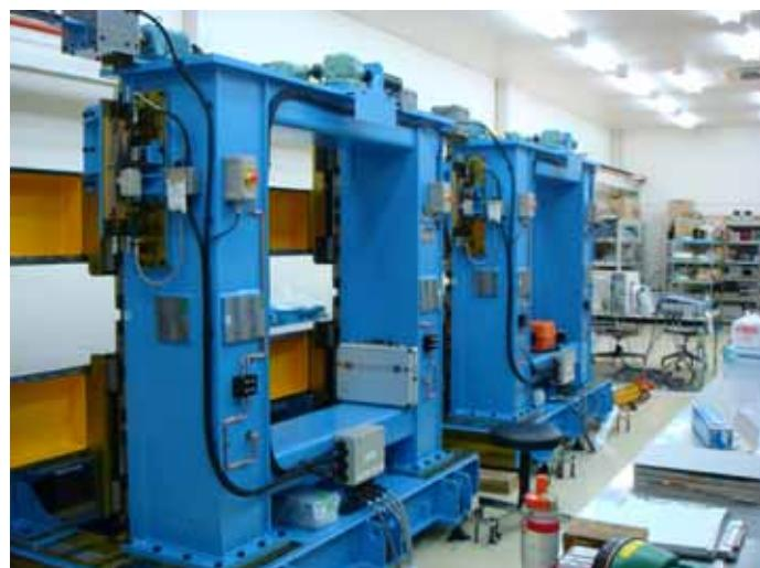
SPring-8に搬入された偏光制御型軟X線アンジュレータ（本体部分）
