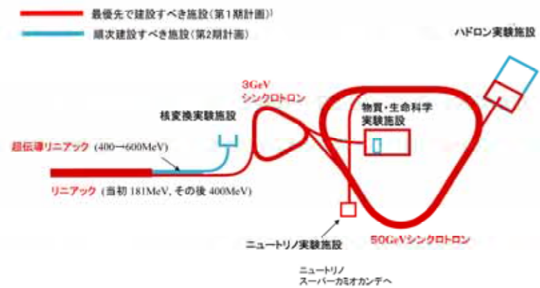
図5 J-PARCの大強度陽子加速器群(リニアック、3GeVシンクロトロン、50GeVシンクロトロン)と実験施設群。物質・生命科学実験施設では中性子とミュオンが利用される(J-PARCセンター提供)。
