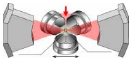
図1 高圧装置とビームアラインメントの概念図
