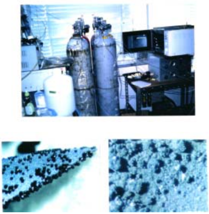
図3 気相成長で作成したダイヤモンド。上図は製作にもちいた電子レンジ（電子レンジの中を希薄気体のチューブを通し放電させた）。下図は気相成長させたダイヤモンド（左）とグラファイト（右）。ダイヤモンドは水素99%、メタン1%で、グラファイトは水素95%、メタン5%の条件で気相成長させた。シリコン基板の上のダイヤモンドは数10ミクロンの大きさ。
