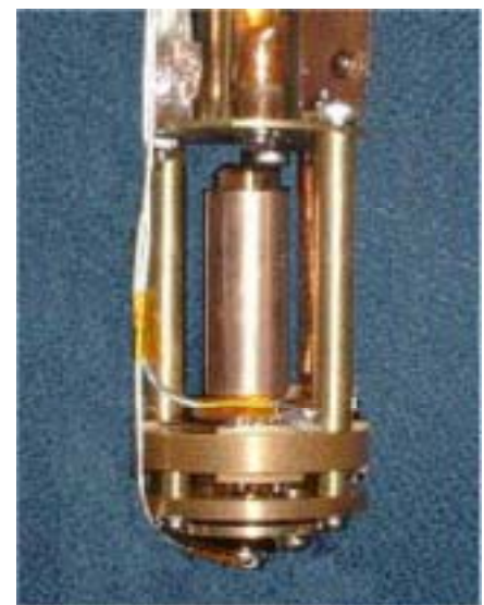
図5 圧力容器を乗せたキャパシタンスセル。
