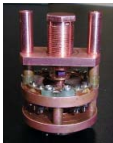
図 15 熱膨張測定用キャパシタンスセル。
