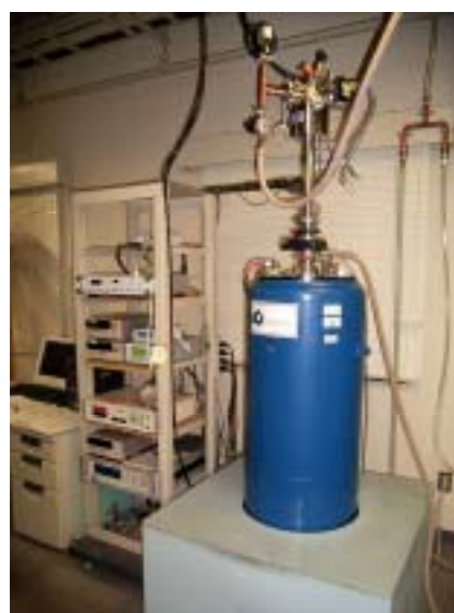
図7 角度分解の磁場中比熱測定装置.
