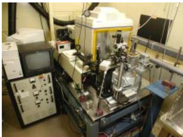
図3. 超高压高温 X線その場観察システム
