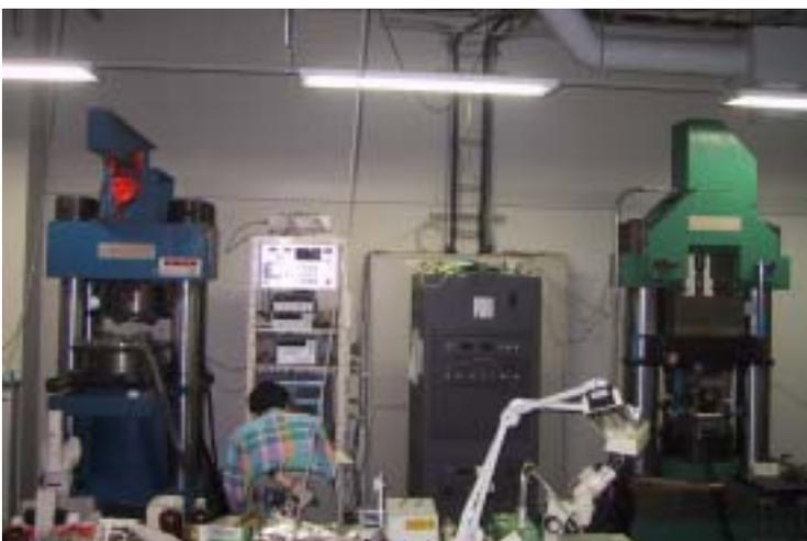
図2. マルチアンビル高温高压実験装置
