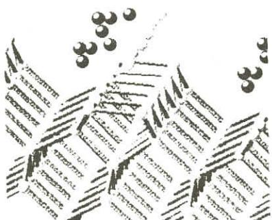
図1 : Si(001)-2×3-Ag 表面構造モデル。
