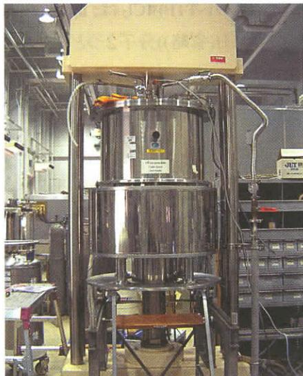
図2a：キュービックアンビル圧力発生装置
