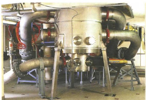
図 4. グルノーブル強磁場施設の20MWビッター型電磁石。本体は地下1階に設置され、冷凍機(クライオスタット)や測定器はすぐ上1階の実験室にセットされている。
