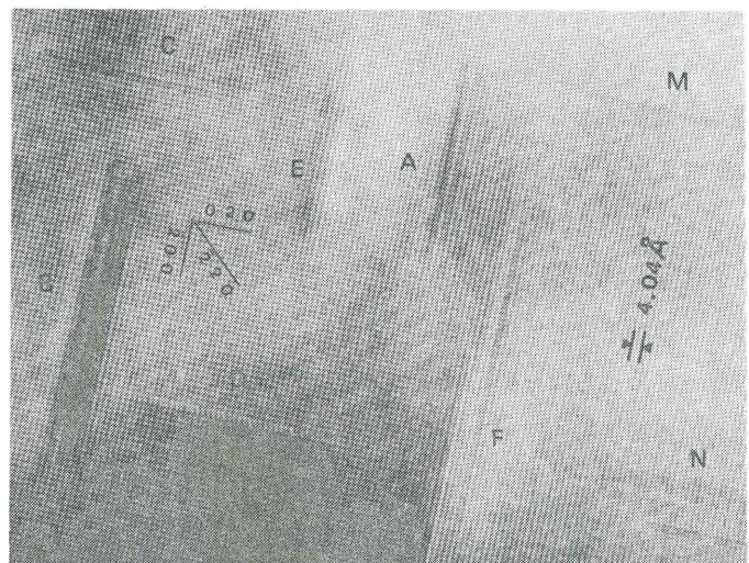
図3 時効したAl-1.7 at % Cu合金(001) 結晶の格子像。A,C,D,EはGP(I)ゾーン、B,NはGP(II)ゾーン。
