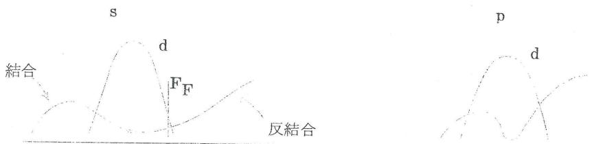
s電子状態密度の小さくなっている結合。反結合状態の中間に来るためである。NiとFeにおける差はs電子とp電子の状態密度の違いによる。
