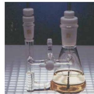
定電流電解法で有機超伝導体の単結晶を育成 (写真提供: 森研究室)
