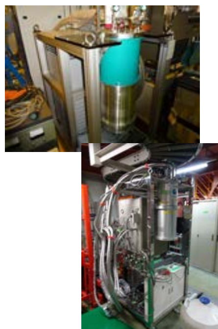
図 4, 5：無冷媒極低温冷凍機
