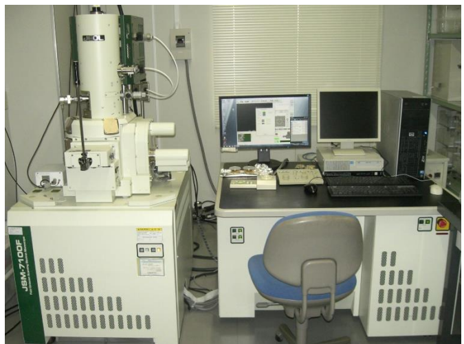
図3. クリーンルームに導入したSEM(JEOL JSM-7100F)
