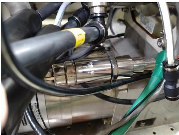
図1 真空計(ミニチュアゲージ)
