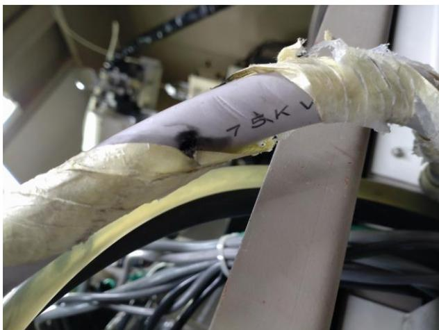
図2 高圧ケーブルの破損
