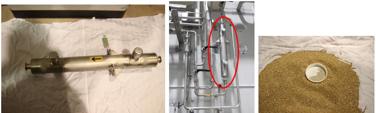
図 2. 水素除去器(左)、取付部 (中央)、吸着剤 (右)
