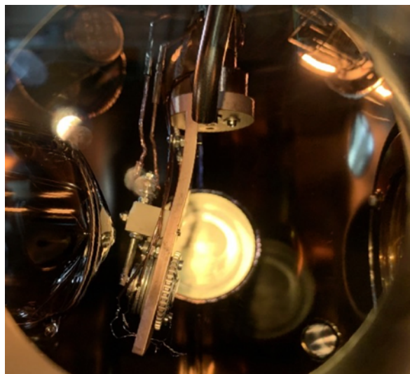
図 衝突後の歪曲したサンプルホルダー
