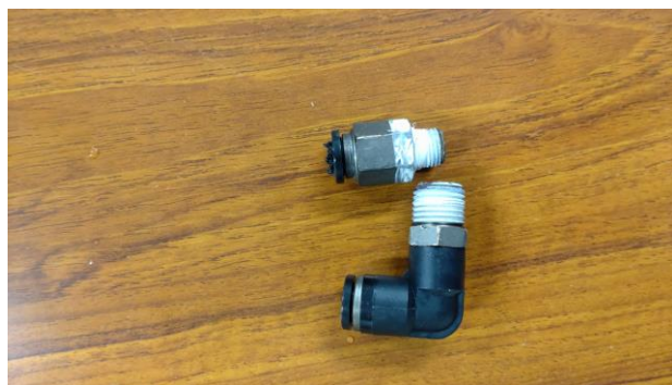
図2 水漏れの原因になった部品
