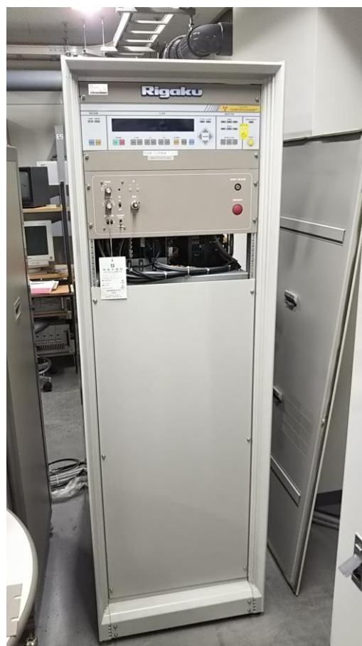
図 1: 大型 IP-X 線回折装置の制御基板やトランス等が入っているキャビネット
