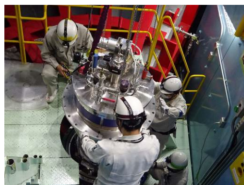
図 3：超電導マグネットを HRC へ 搭載する様子
