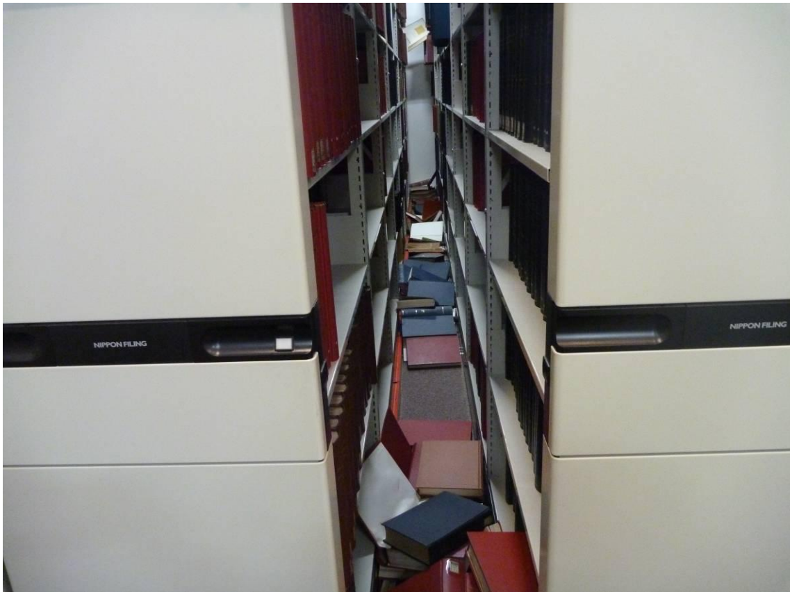
余震で書架間に隙間が出来、そこに資料が落下
