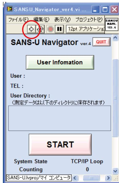
左上の白抜き矢印のボタンを押すと、SANS-U I/O Panel (LocalControlPanel rev3.vi) が表示される。このとき各モーターが現在の位置を読みに行くか確認する。この時、前回終了した際に（自動）保存されたモーターのステータス情報がMotorマネージャに転送される。読みに行かない場合は、再度起動が必要。先ほど立ち上げた SANS-U\_control.viを一旦終了させてから、手順1からやり直す。
