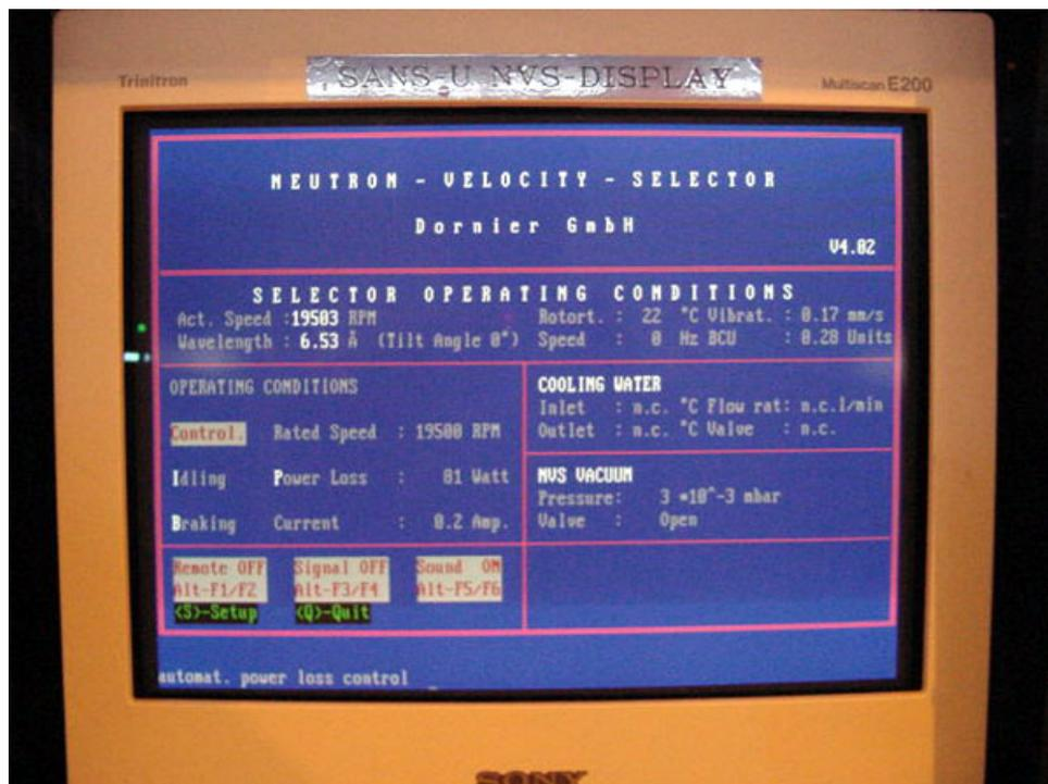
4.真空度が十分であり (0.003mbar以下)、他の項目も警告表示がない (白くフラッシュしていない) ことをPCモニター上で確認し、キーボードから「C」キーを押す。回転数が3100 rpmに自動設定され回転を始める (時々失敗することがあるが、勝手に再起動するのでしばらく待つ)。
