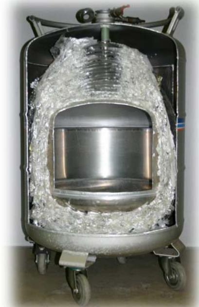
図8 ヘリウム容器の構造
