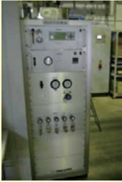
①⑦, ①⑦-2 Heガス分析計 Linde社製 O 2 , H 2 O, C x H y , N 2 検出可能
