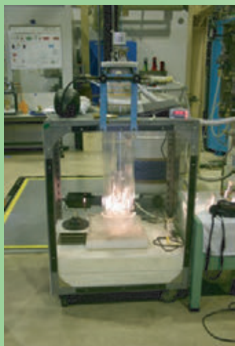
デモ実験用ガラスデュワー 液体ヘリウムを直に目で見る ことができる他、超流動、超伝導 のデモ実験が行える。
