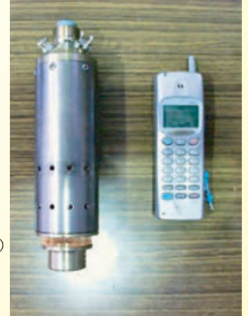
⑬遠心式ヘリウム汲上ポンプ 20 L/min 120rps
